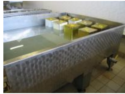
Şekil 2: Kristalleşmiş balın sıcak su banyolarında bekletilerek çözdürme işlemi
