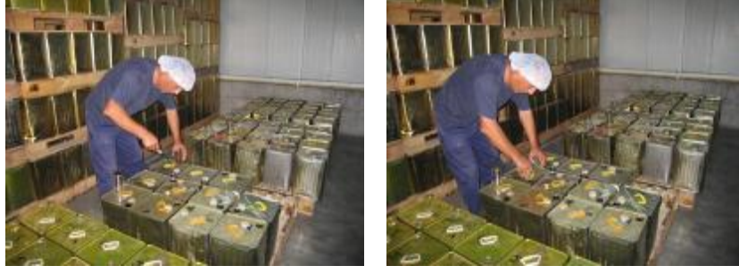
Şekil 4: Süzme balda tenekelerden numune alma işlemi
